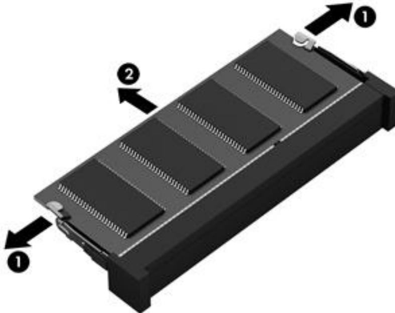
Bewahren Sie Speichermodule nach dem Entnehmen in einem elektrostatikgeschützten Behältnis auf.
