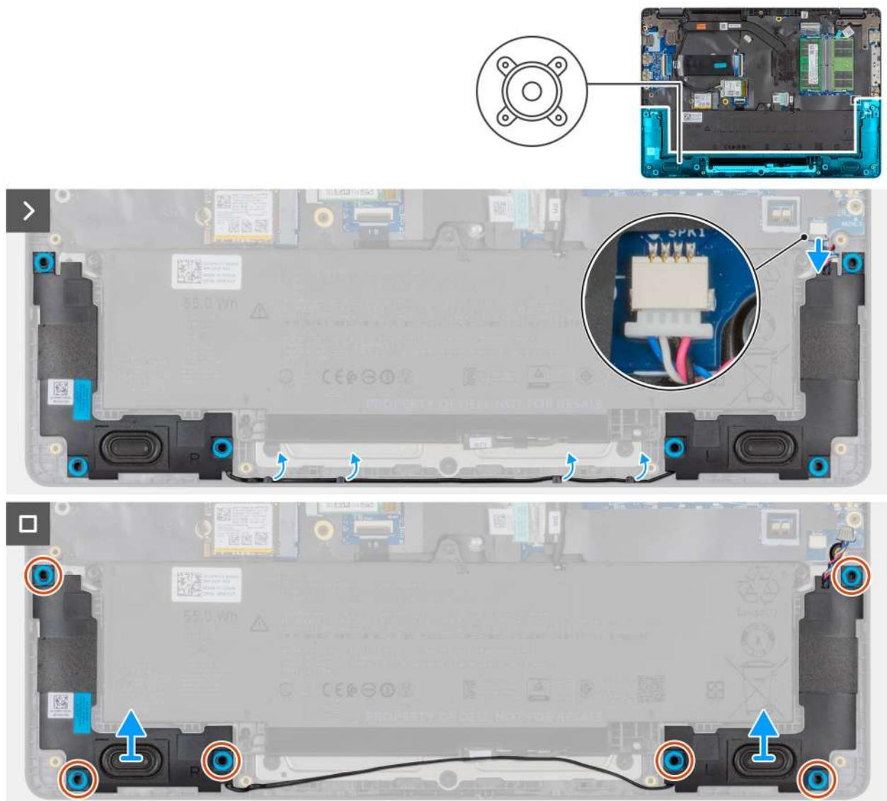
Abbildung 27. Entfernen der Lautsprecher
