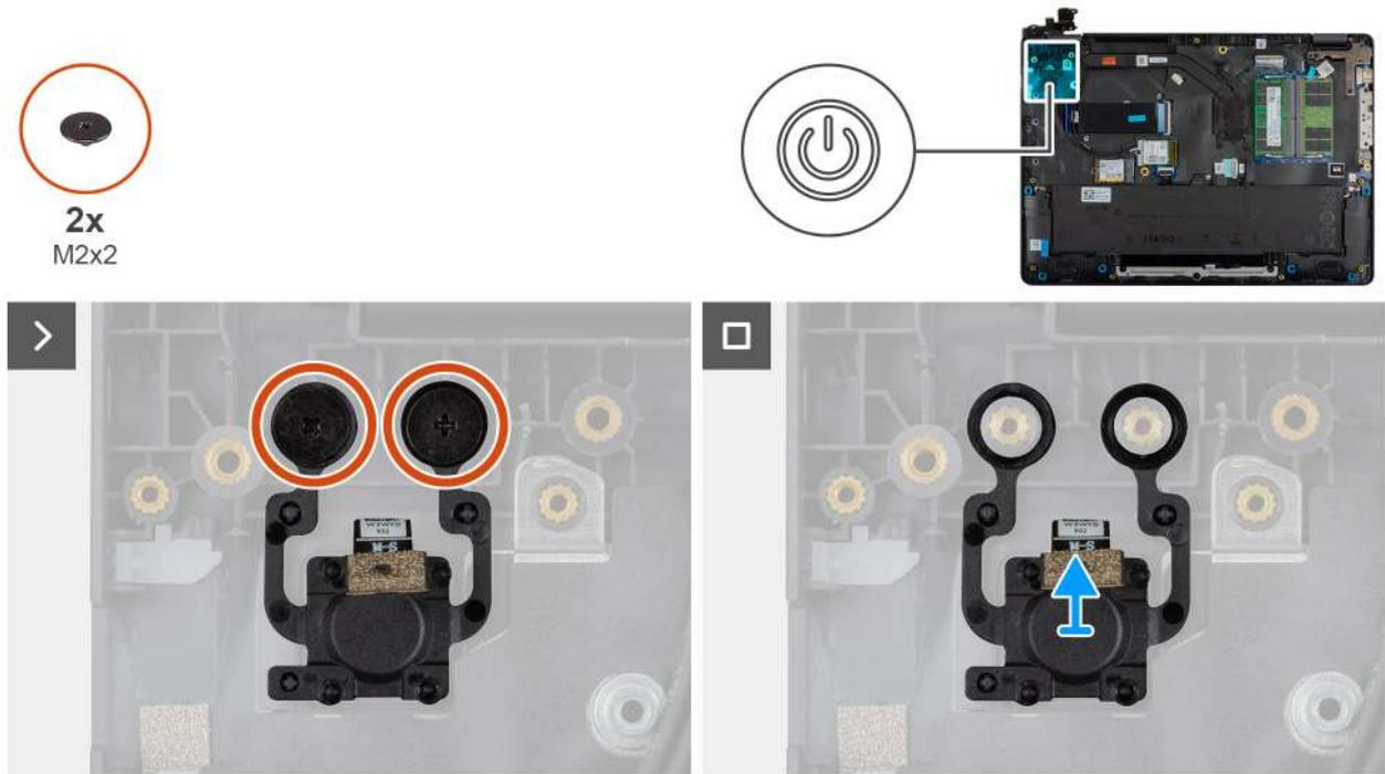
Abbildung 44. Entfernen des Netzschalters mit Fingerabdruck-Lesegerät
