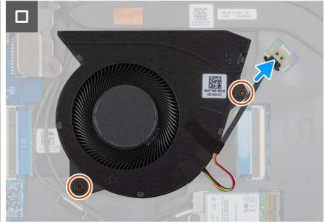
Abbildung 31. Einbauen des Lüfters
