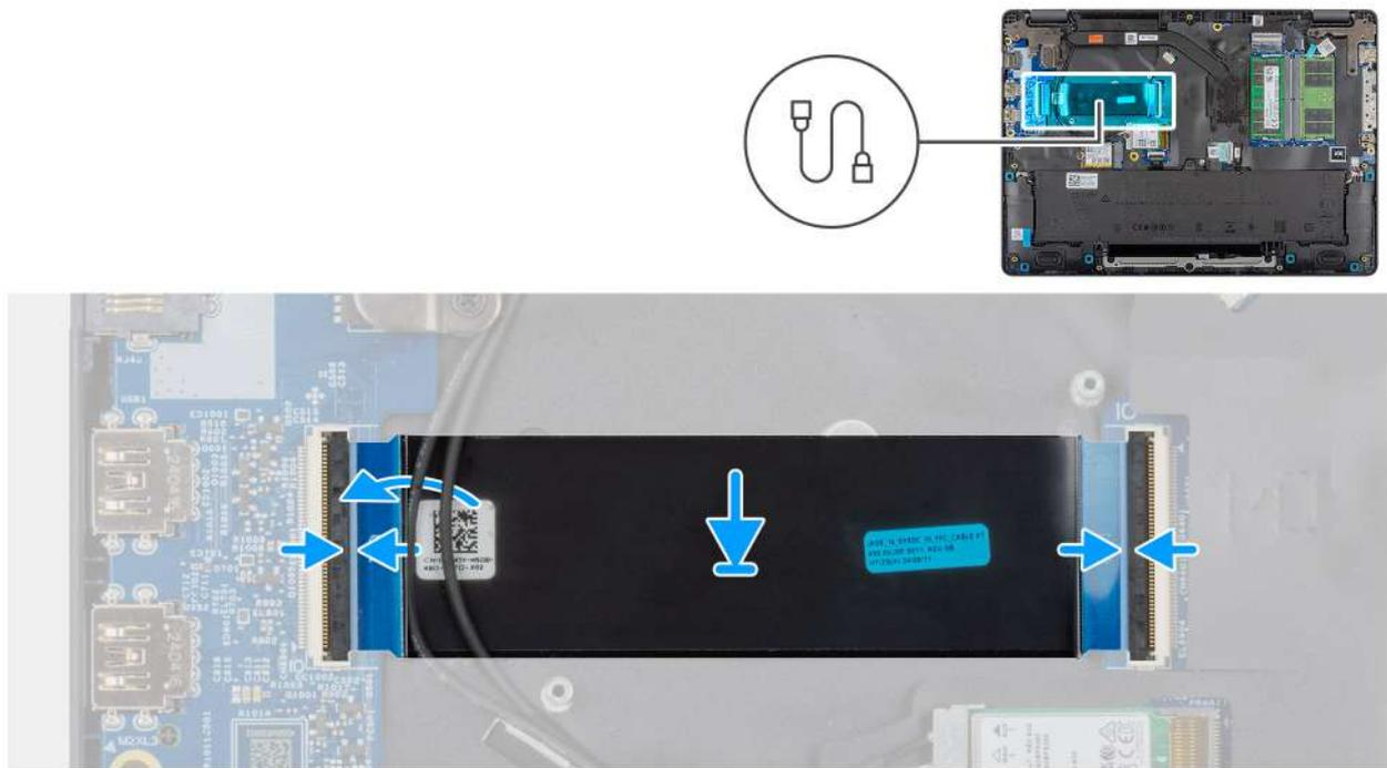
Abbildung 43. Installieren des FPC-Kabels der I/O-Platine
