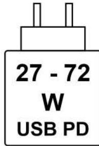
**Abbildung 9. Piktogramm für die Anforderungen an die Stromversorgung**
