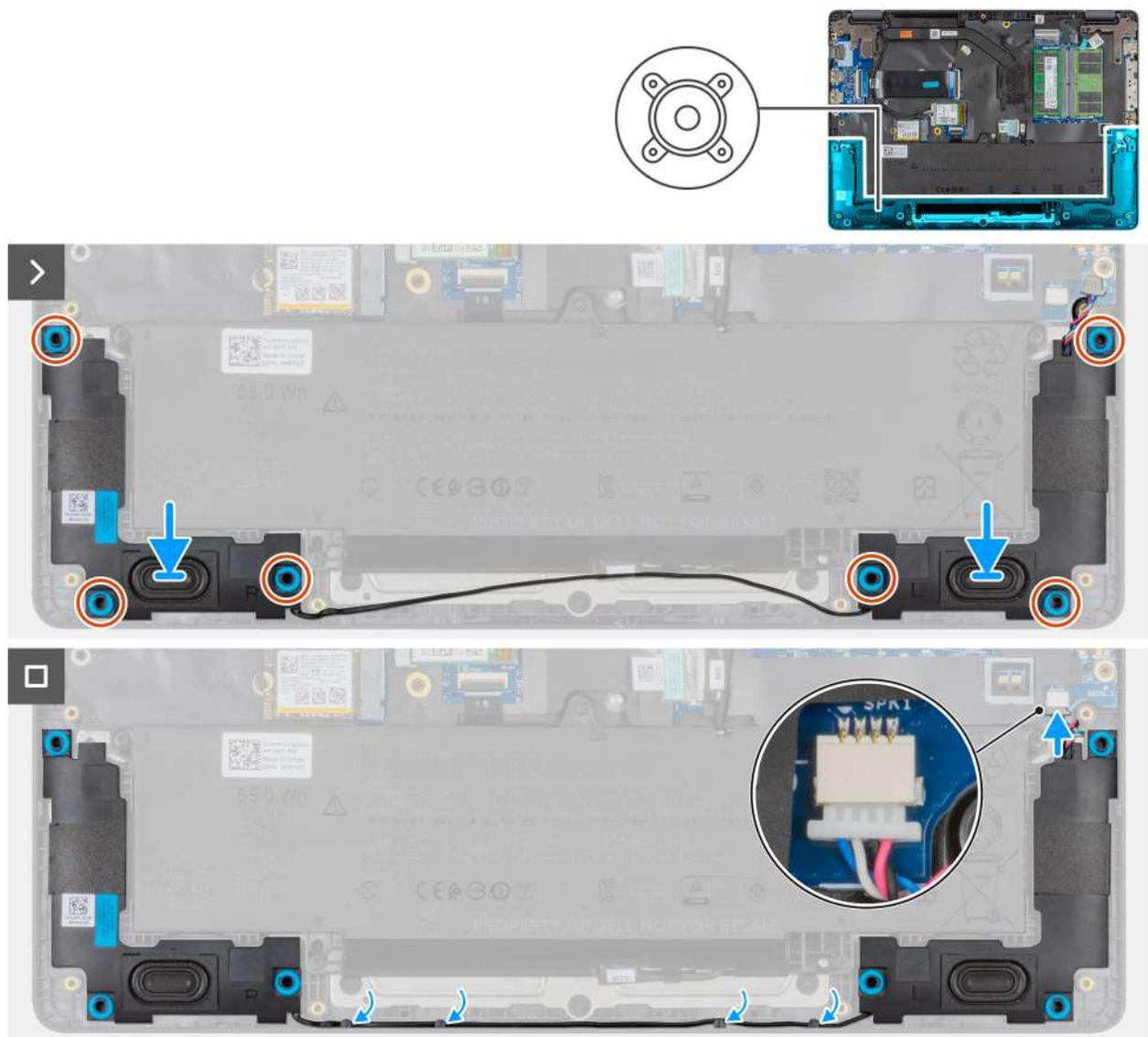
Abbildung 28. Installieren der Lautsprecher
