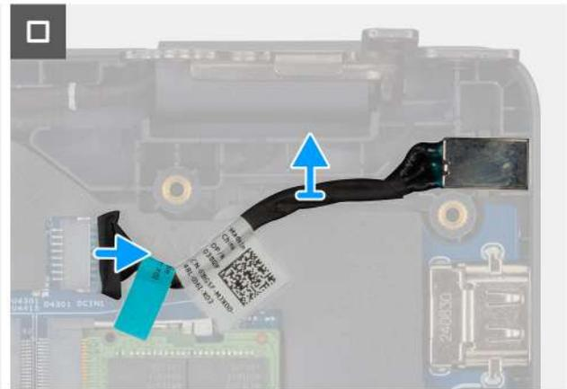
Abbildung 32. Entfernen des Netzadapteranschlusses
