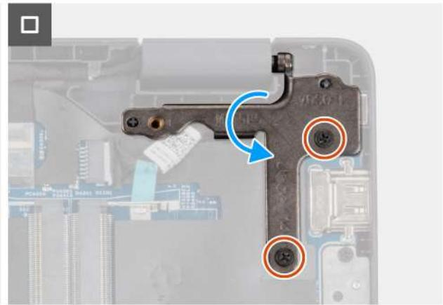
Abbildung 33. Einbauen des Netzadapteranschlusses
