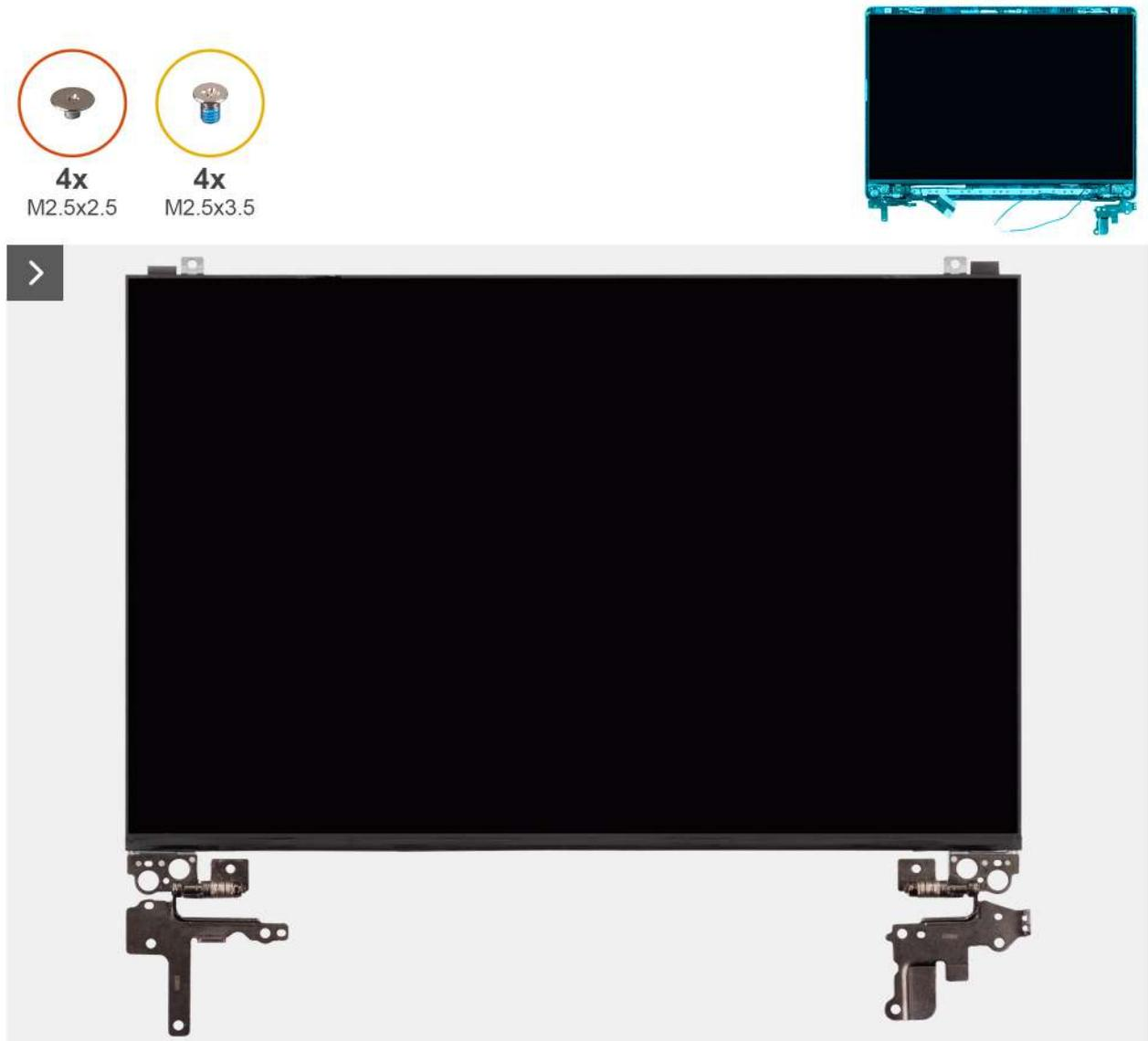
Abbildung 88. Installieren der Bildschirmbaugruppe
