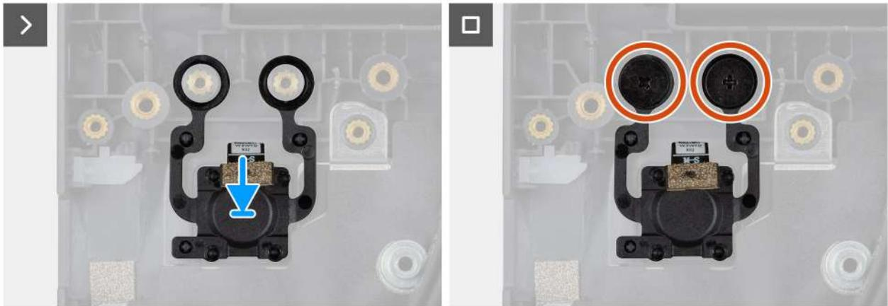
Abbildung 45. Einbauen des Netzschalters mit Fingerabdruck-Lesegerät
