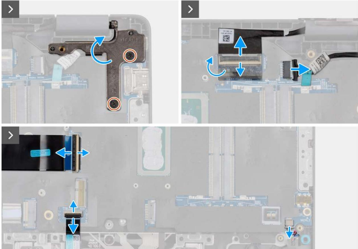
Abbildung 47. Entfernen der Systemplatine
