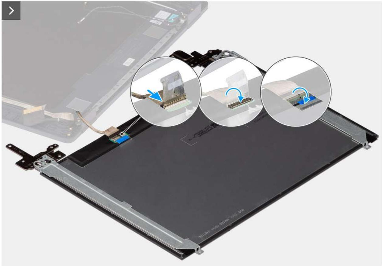
Abbildung 89. Installieren der Bildschirmbaugruppe
