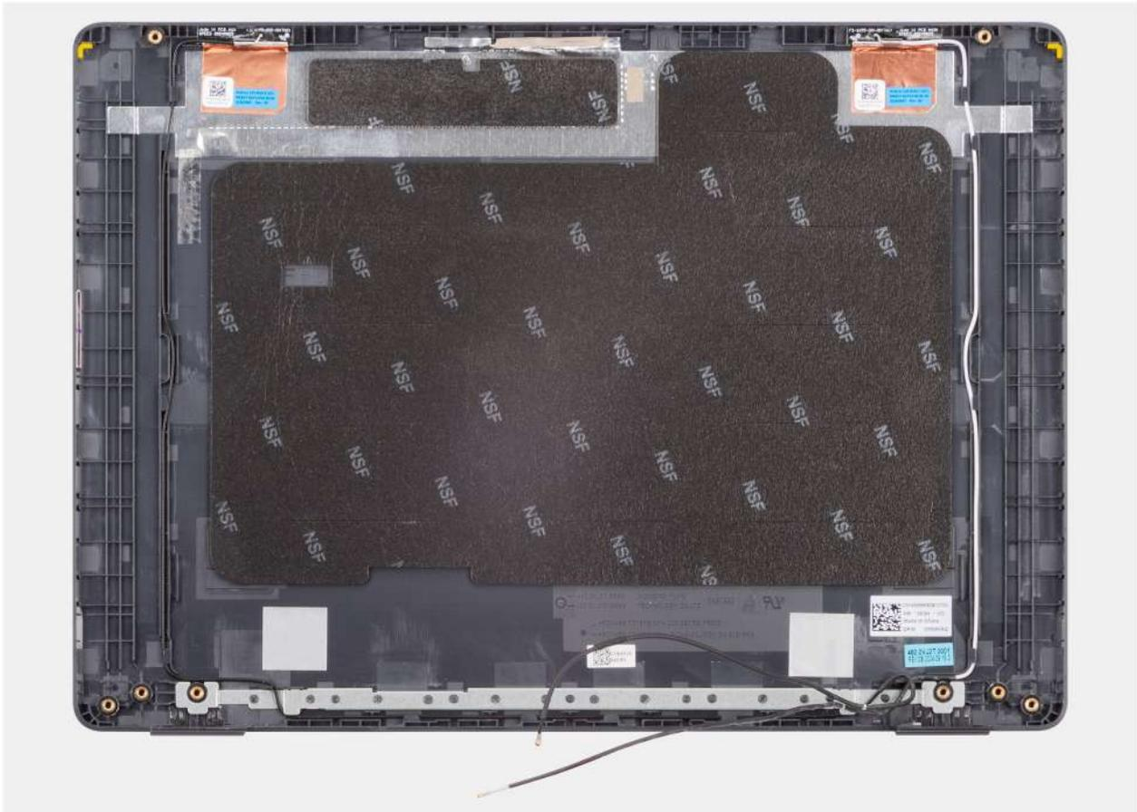
**Abbildung 96. Entfernen der Baugruppe der hinteren Bildschirmabdeckung**
