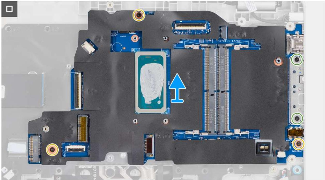
Abbildung 54. Entfernen der Systemplatine
