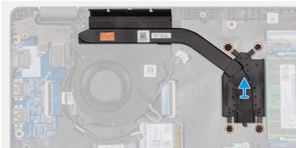
Abbildung 34. Kühlkörper entfernen
