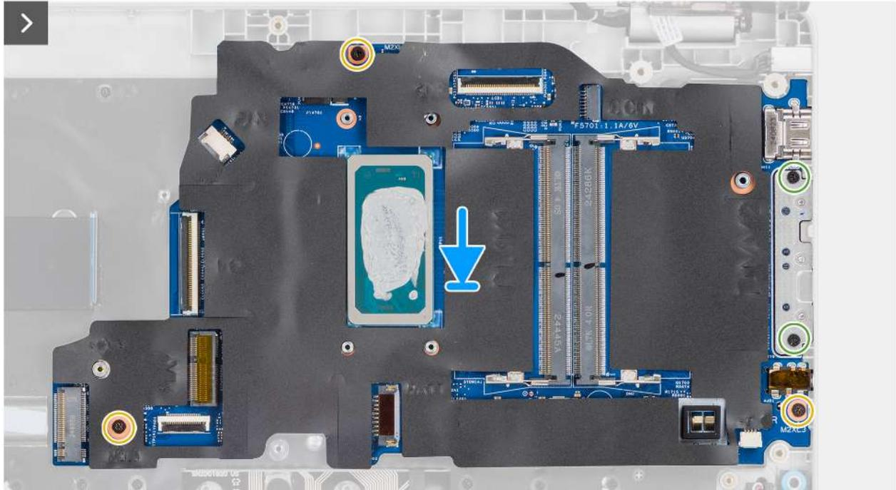
Abbildung 56. Einbauen der Systemplatine
