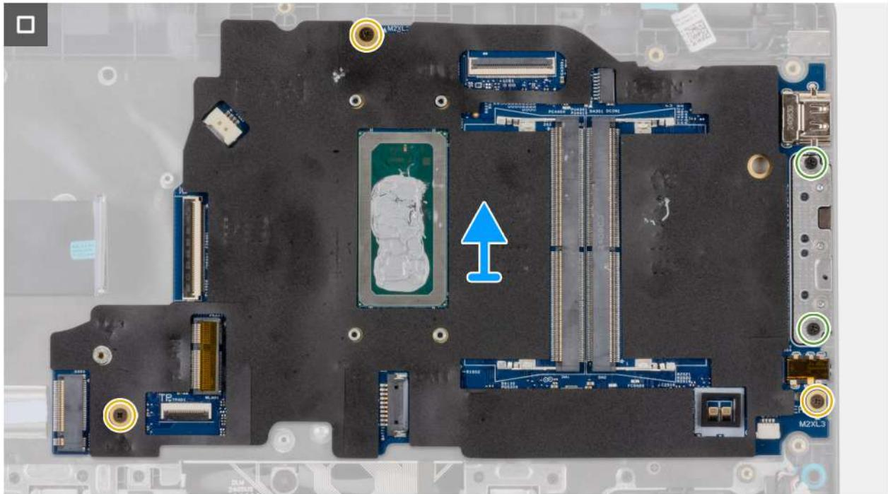
**Abbildung 48. Entfernen der Systemplatine**
