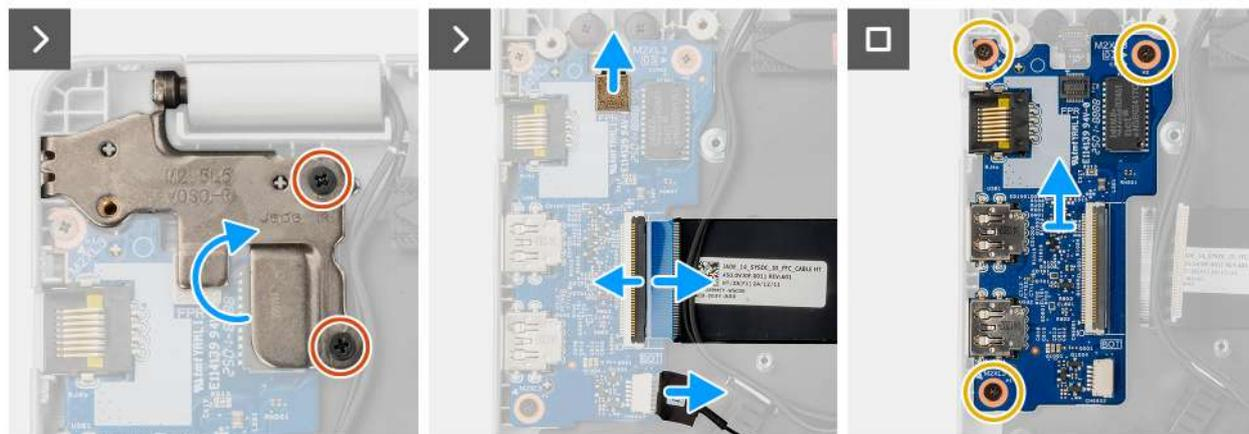
Abbildung 40. Entfernen der E/A-Platine
