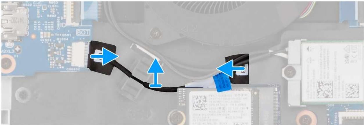
Abbildung 36. Entfernen des vPro-Kabels
