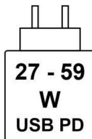
**Abbildung 8. Piktogramm für die Anforderungen an die Stromversorgung**
