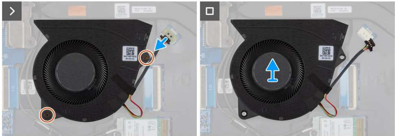
Abbildung 30. Entfernen des Lüfters
