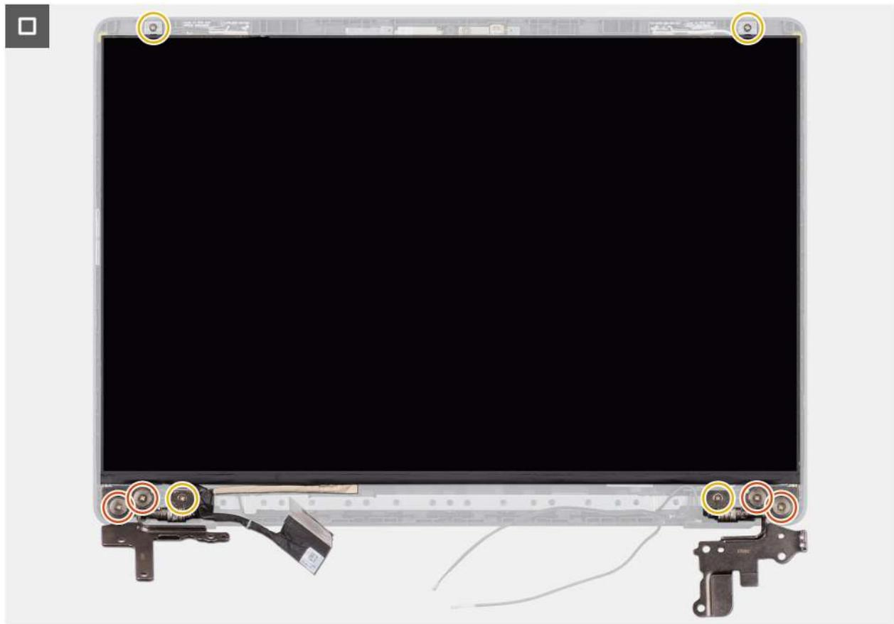
Abbildung 91. Installieren der Bildschirmbaugruppe
