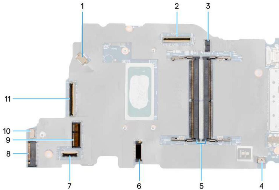
**Abbildung 55. Hauptplattenanschlüsse**
