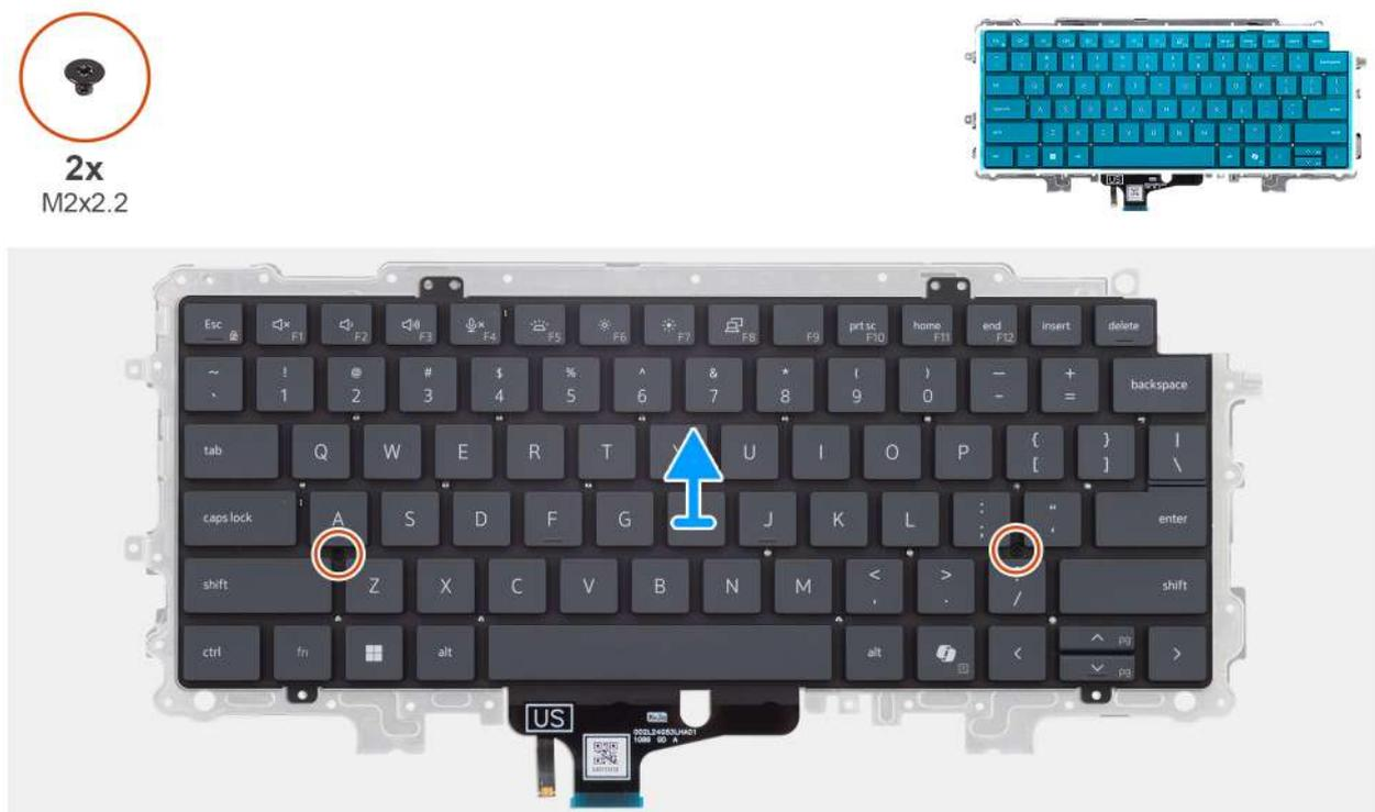
Abbildung 66. Entfernen der Tastaturstützplatte
