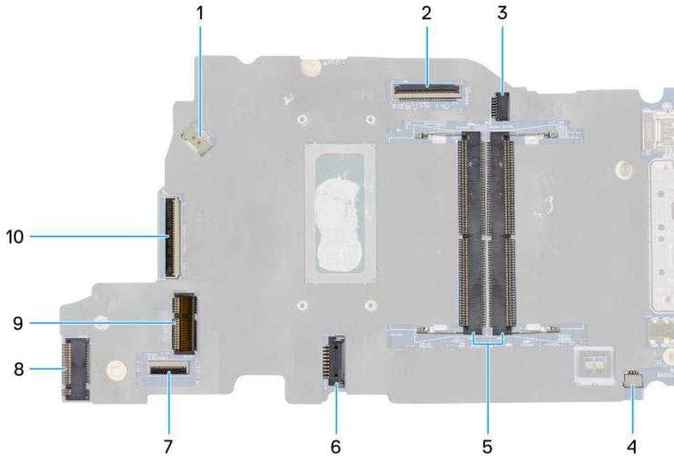
**Abbildung 46. Hauptplattenanschlüsse**
