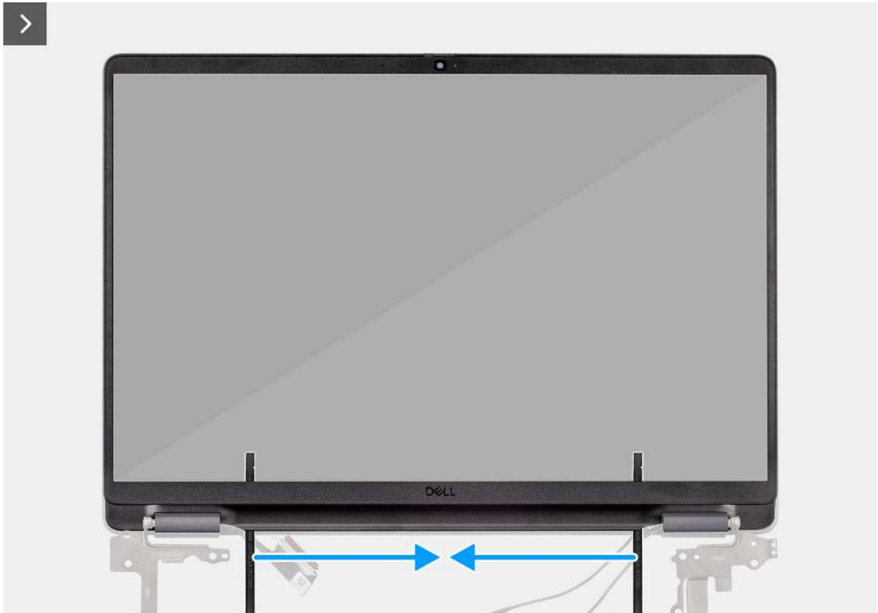
Abbildung 78. Entfernen der Bildschirmblende
